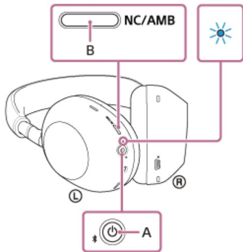
Wenn das Initialisieren abgeschlossen ist, blinkt die Anzeige (blau) 4-mal ( ● - ● - ● - ● - ).
