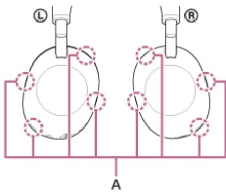
An der linken und rechten Einheit des Headsets befinden sich Mikrofone (A).
