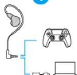
Schließen Sie den Kopfhörer und die mitgelieferte USB-Typ-C-Audiobox wie abgebildet ordnungsgemäß an jedes Gerät an.
