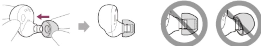
Čvrsto umetnite uložak za uši koliko je moguće. Nemojte postavljati uložak za uši ukrivo i dobro ga pričvrstite. Ako uložak za uši nije u potpunosti pričvršćen, vrh slušalice sa mikrofonom može da spadne sa slušalice sa mikrofonom pa kvalitet zvuka, efekti smanjenja šuma i trajnost mogu da se smanje.
