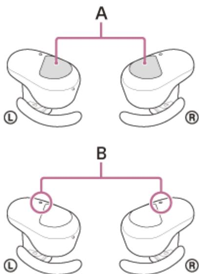
**A:** Dodirni senzori (lijevi, desni)
