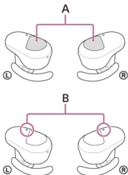
A: Dodirni senzori (lijevi, desni)
