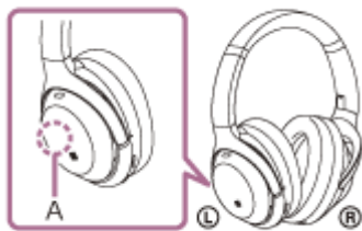
A: Position der integrierten Antenne
