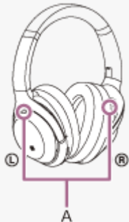
A: Mikrofon für Rauschunterdrückungsfunktion (extern)
