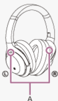
A: Μικρόφωνο λειτουργίας εξουδετέρωσης θορύβου (εξωτερικό)
