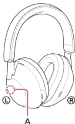
A: Position der integrierten Antenne
