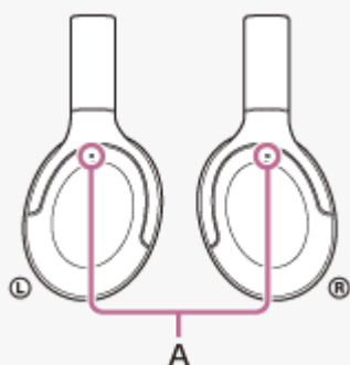
A: Microfoane pentru funcția de anulare a zgomotului
