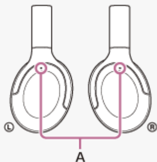
A: Brusreduceringsfunktionens mikrofoner
