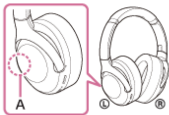
A: Den indbyggede antennes placering
