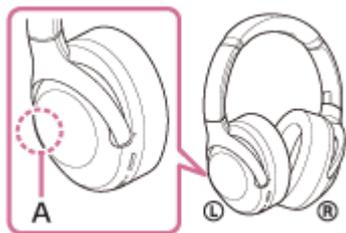
**A** : emplacement de l'antenne intégrée
