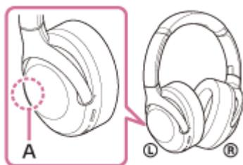
**A** : emplacement de l'antenne intégrée
