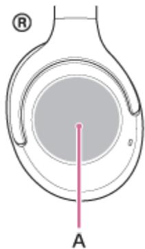
A : Panneau de commande du capteur tactile
