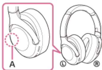
A: Umiestnenie vstavanej antény
