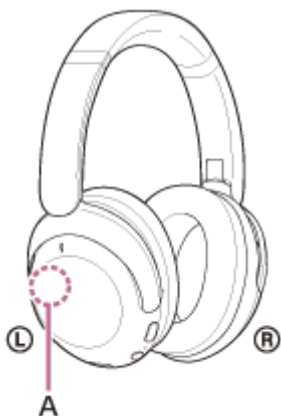
A: Position der integrierten Antenne
