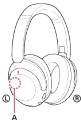
A: locatie van de ingebouwde antenne
