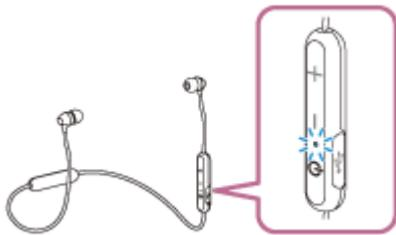
Nachdem sich das Headset eingeschaltet hat, hören Sie die Sprachführung „BLUETOOTH connected“ (BLUETOOTH verbunden), wenn es sich automatisch mit dem zuletzt verbundenen Gerät verbunden hat. Überprüfen Sie den Verbindungsstatus am Android-Smartphone. Wenn das Gerät nicht verbunden ist, fahren Sie mit Schritt 3 fort.
