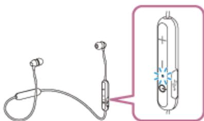
Nachdem sich das Headset eingeschaltet hat, hören Sie die Sprachführung „BLUETOOTH connected“ (BLUETOOTH verbunden), wenn es sich automatisch mit dem zuletzt verbundenen Gerät verbunden hat. Prüfen Sie am Computer, ob die Verbindung hergestellt wurde. Wenn die Verbindung nicht hergestellt wurde, fahren Sie mit Schritt 3 fort.
