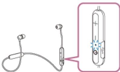
Nachdem sich das Headset eingeschaltet hat, hören Sie die Sprachführung „BLUETOOTH connected“ (BLUETOOTH verbunden), wenn es sich automatisch mit dem zuletzt verbundenen Gerät verbunden hat. Überprüfen Sie den Verbindungsstatus am iPhone. Wenn das Gerät nicht verbunden ist, fahren Sie mit Schritt 3 fort.
