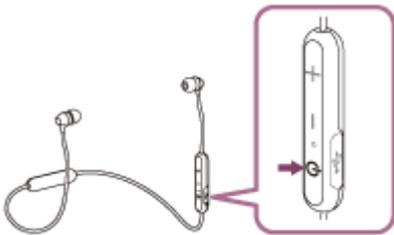
Nach dem Loslassen der Taste muss die Anzeige (blau) blinken. Sie hören die Sprachführung „Power on“ (Einschalten).
