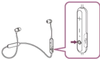
Nach dem Loslassen der Taste muss die Anzeige abwechselnd blau und rot blinken. Sie hören die Sprachführung „BLUETOOTH pairing“ (BLUETOOTH-Kopplung).
