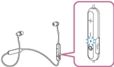
Nachdem sich das Headset eingeschaltet hat, hören Sie die Sprachführung „BLUETOOTH connected“ (BLUETOOTH verbunden), wenn es sich automatisch mit dem zuletzt verbundenen Gerät verbunden hat. Überprüfen Sie den Verbindungsstatus am Bluetooth-Gerät. Wenn das Gerät nicht verbunden ist, fahren Sie mit Schritt 2 fort.
