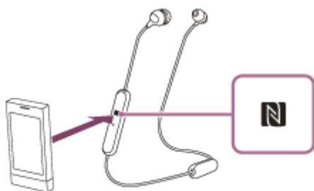
Befolgen Sie die angezeigten Anweisungen, um die Kopplung durchzuführen und die Verbindung herzustellen. Wenn das Headset mit dem Smartphone verbunden ist, blinkt die (blaue) Anzeige langsam. Sie hören die Sprachführung „BLUETOOTH connected“ (BLUETOOTH verbunden).
