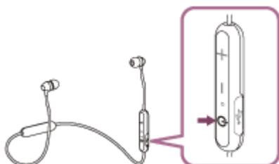
Nach dem Loslassen der Taste muss die Anzeige abwechselnd blau und rot blinken. Sie hören die Sprachführung „BLUETOOTH pairing“ (BLUETOOTH-Kopplung).
