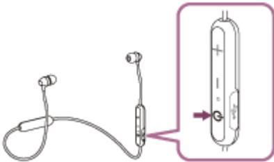
Nach dem Loslassen der Taste muss die Anzeige (blau) blinken. Sie hören die Sprachführung „Power on“ (Einschalten).
