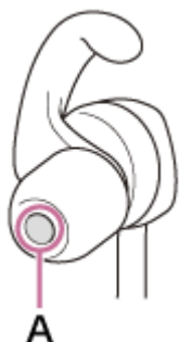
A: conducto del sonido (tubo de salida del sonido)
