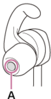
A：ヘッドセット音導管（音出口の筒部）
