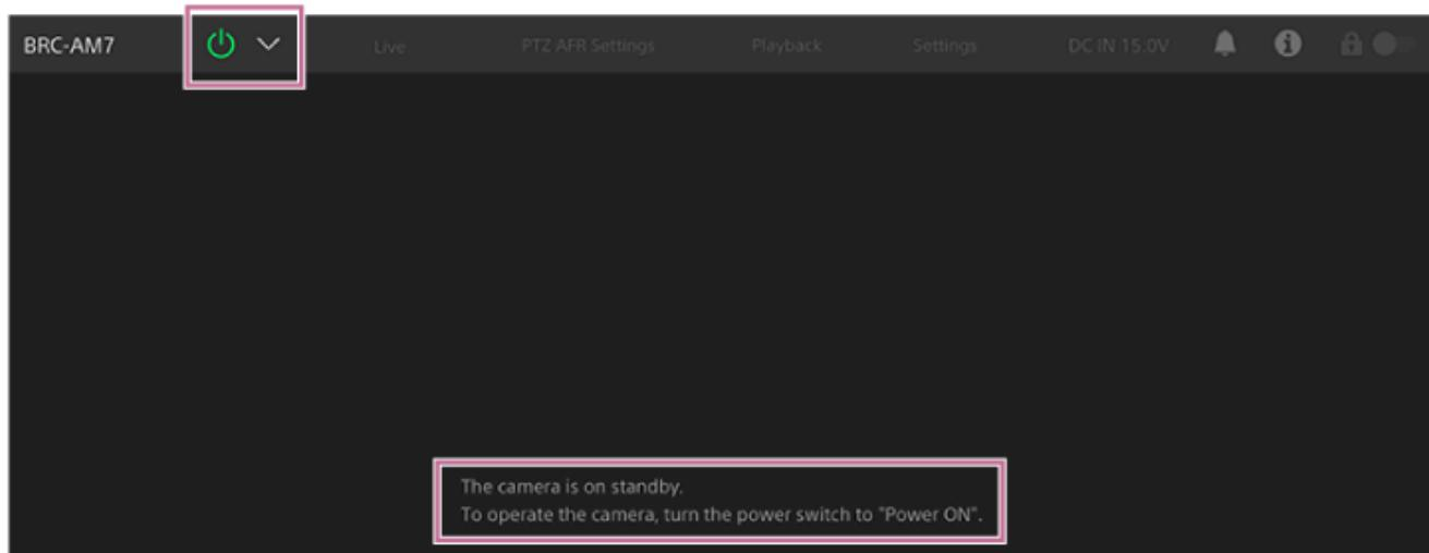
Pulse el interruptor de alimentación y seleccione [Power ON] en el menú de interruptores. La unidad se enciende, el indicador POWER se ilumina en verde en la parte delantera de la unidad y la imagen de la cámara aparece en la pantalla de operación en directo de la Aplicación Web.
