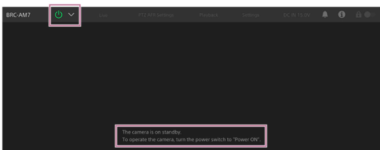
Para volver a encender la alimentación, pulse el interruptor de alimentación y seleccione [Power ON] en el menú de interruptores.
