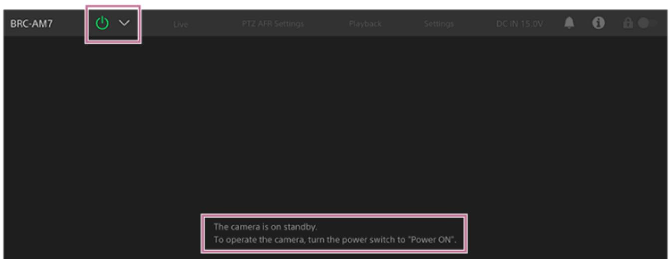
Pour remettre l'appareil sous tension, appuyez sur le commutateur d'alimentation et sélectionnez [Power ON] dans le menu de commutation.
