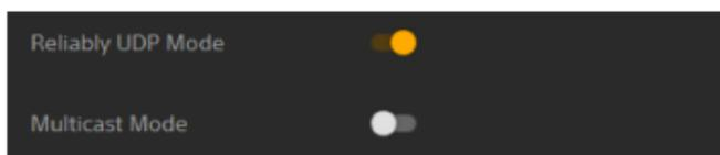
Appuyez sur le commutateur pour activer/désactiver l'élément. Le commutateur apparaît en orange lorsque l'élément est activé et en blanc s'il est désactivé.
