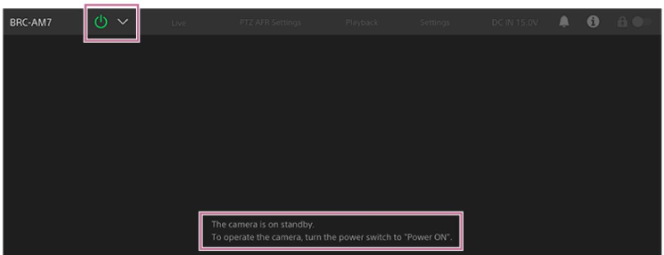
Appuyez sur le commutateur d'alimentation et sélectionnez [Power ON] dans le menu de commutation. L'appareil se met sous tension, le témoin POWER s'allume en vert à l'avant de l'appareil, et l'image de caméra apparaît sur l'écran d'opération en direct de l'application Web.
