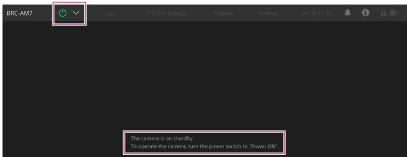
Premere il pulsante di alimentazione e selezionare [Power ON] nel menu di accensione. L'unità si accende, l'indicatore POWER sul lato anteriore dell'unità si illumina con luce verde e l'immagine proveniente dalla telecamera viene visualizzata nella schermata delle operazioni live dell'app Web.
