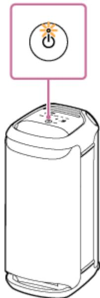
Quando for detetada uma anomalia, desligue o altifalante, desligue o cabo de alimentação de CA, aguarde um pouco e depois reinicie o altifalante (mantendo premido o botão
