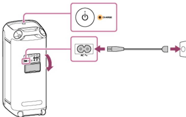
O carregamento da bateria inicia-se e o indicador CHARGE acende uma luz laranja. O carregamento está concluído após cerca de 3 horas\* e o indicador apaga-se.
