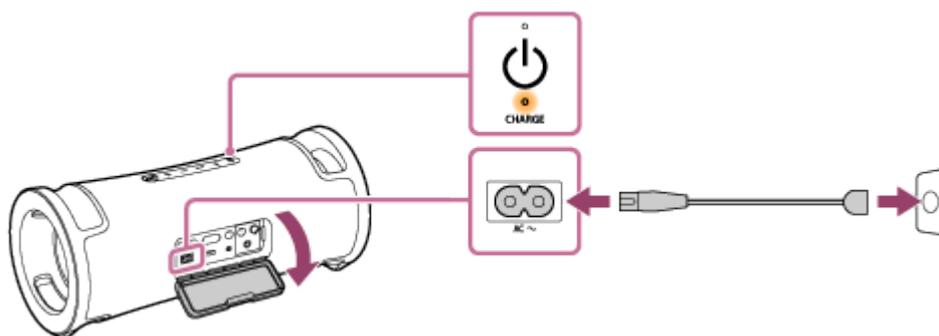
O carregamento da bateria inicia-se e o indicador CHARGE acende uma luz laranja. O carregamento está concluído após cerca de 5 horas\* e o indicador apaga-se.
