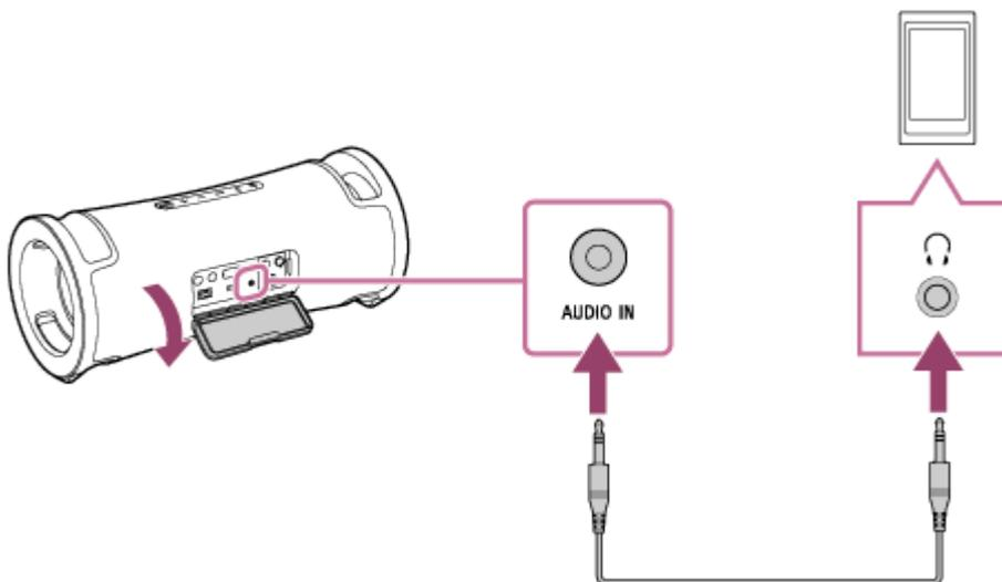
\* Se utilizar um cabo de som (com minifichas estéreo) com resistência significativa, o som pode estar mais baixo. Por isso, assegure-se de que utiliza um cabo (com minifichas estéreo) sem resistência.
