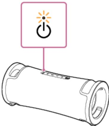
Se for detetada uma anomalia, desligue o cabo de alimentação de CA, aguarde um pouco e depois reinicie o altifalante (mantendo premido o botão
