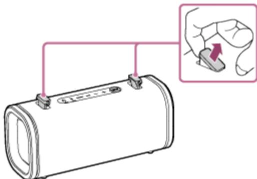
2. Gire la tapa de almacenamiento del lado izquierdo en el sentido horario como se muestra en la ilustración. Mientras sujetas y levanta el bucle de fijación con los dedos, empuje la tapa de almacenamiento hacia abajo.
