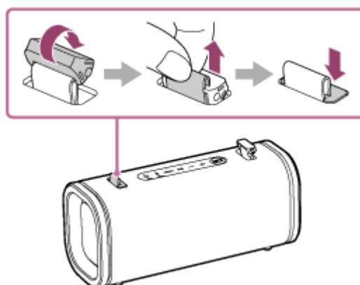
3. Gire la tapa de almacenamiento del lado derecho en sentido antihorario como se muestra en la ilustración. Mientras sujetas y levanta el bucle de fijación con los dedos, empuje la tapa de almacenamiento hacia abajo.
