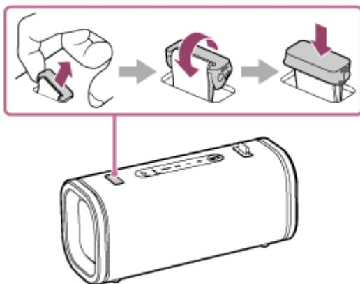
3. Enganche su dedo en la lengüeta de la tapa de almacenamiento en el lado derecho y levántela. Gire la tapa de almacenamiento en sentido horario como se muestra en la ilustración y empújela hacia abajo.
