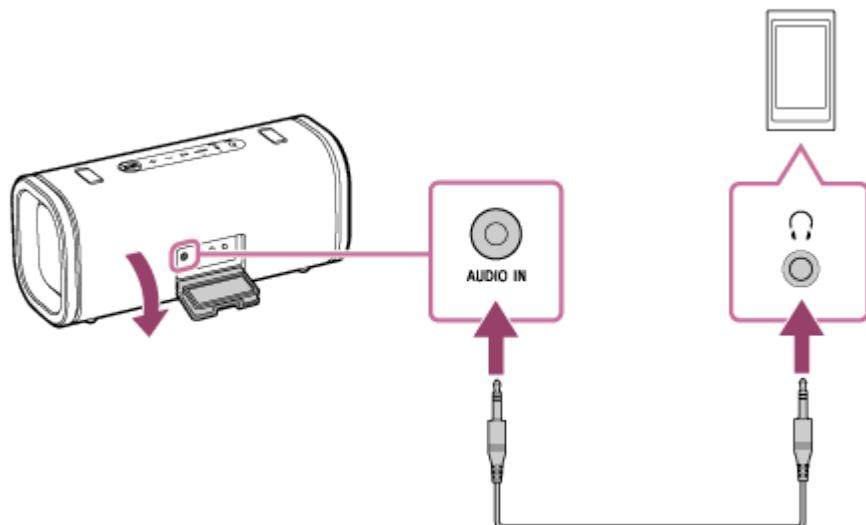
\* Si utiliza un cable de audio (con miniclavijas estéreo) con una resistencia considerable, el volumen podría ser más bajo. Por lo tanto, asegúrese de utilizar un cable (con miniclavijas estéreo) sin resistencia.
