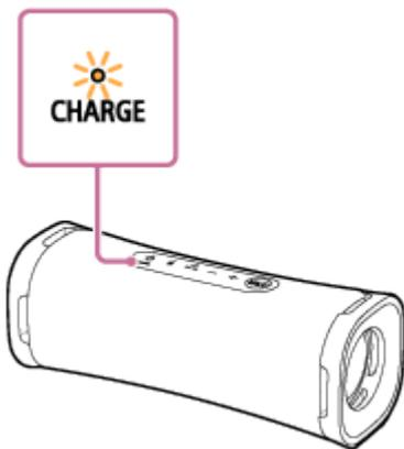
如检测到异常，则断开USB连接线连接，稍候片刻，然后重启扬声器（按下并按住  $\text{⏻}$ （电源）按钮约10秒）。如果问题仍然存在，请联系就近的Sony经销商。
