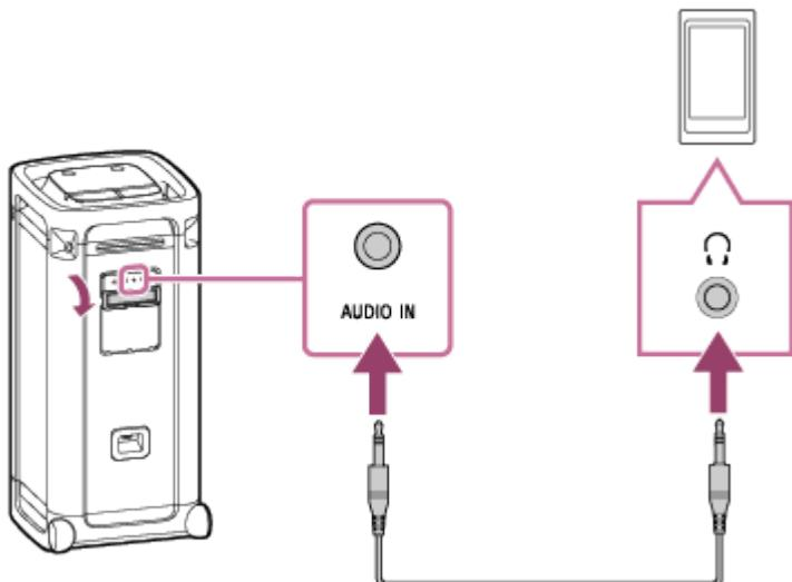
\* Si vous utilisez un câble audio (doté de mini fiches stéréo) avec une résistance significative, le volume risque de baisser. Par conséquent, assurez-vous d'utiliser un câble (doté de mini fiches stéréo) sans résistance.
