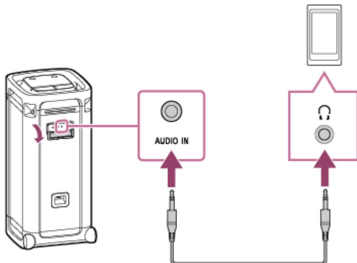
\* Si utiliza un cable de audio (con miniclavijas estéreo) con una resistencia significativa, el volumen puede ser más bajo. Por lo tanto, asegúrese de utilizar un cable (con miniclavijas estéreo) sin resistencia.
