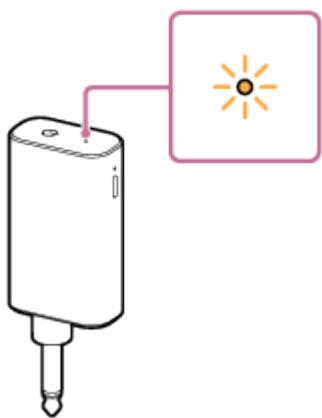
Si se detecta una anomalía, desconecte el cable USB y espere un rato. A continuación, mantén pulsado el botón de encendido del micrófono o receptor durante unos 10 segundos para reiniciarlo. Si el problema persiste, consulte a Sony contacto de soporte o a su distribuidor Sony más cercano.
