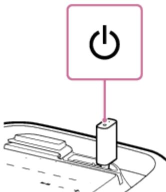
Cuando tanto el micrófono como el receptor estén encendidos, ambos indicadores de encendido parpadearán lentamente en blanco. Una vez finalizada la conexión, los indicadores de encendido pasarán de parpadear a estar encendidos. (\*)
