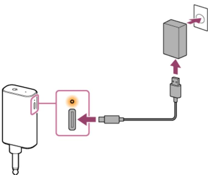
Los indicadores de carga del micrófono y del receptor se iluminan en naranja durante la carga. Los indicadores se apagan cuando finaliza la carga.
