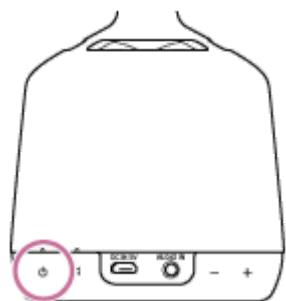
스피커를 켜면 스피커는 마지막으로 연결된 BLUETOOTH장치와 BLUETOOTH 연결을 시도합니다. 스피커가 근처에 이전에 연결된 BLUETOOTH 장치가있는 경우 스피커를 켜기 만하면 스피커가 자동으로 해당 장치에 연결되어 BLUETOOTH 표시등이 흰색으로 켜집니다. 이 경우 BLUETOOTH 기능을 끄거나 현재 연결된 BLUETOOTH 장치의 전원을 끄십시오.
