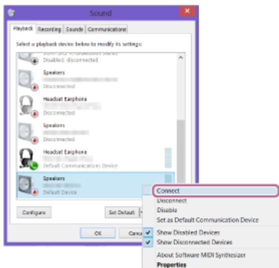
连接扬声器后，[Sound]画面上的[LSPX-S2 Stereo]旁将出现一个复选标记。转至步骤 ⑥。
