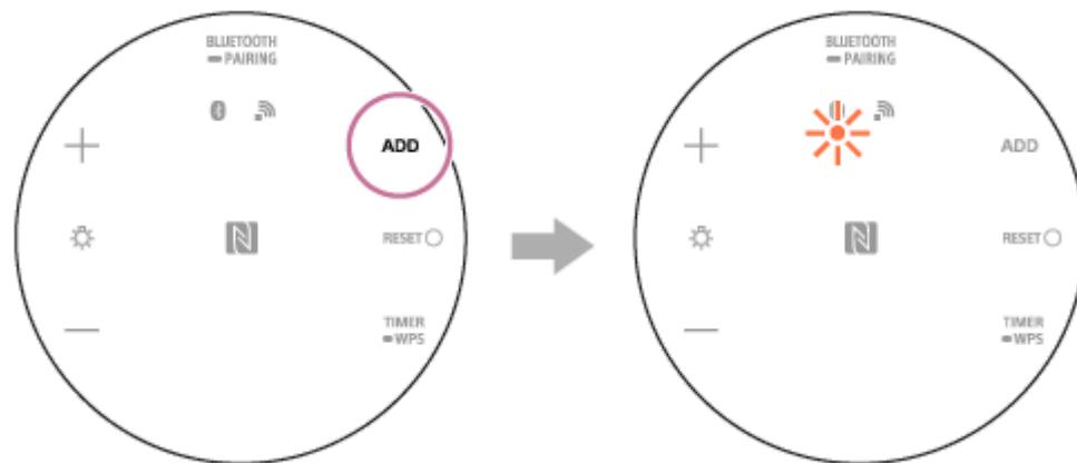
**2 操作其BLUETOOTH指示灯正在闪烁的扬声器（主机），以连接至BLUETOOTH设备。**
