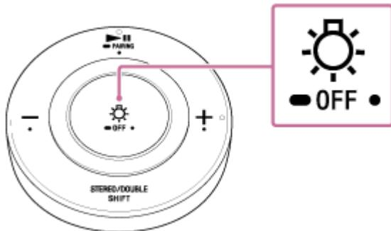
照明が消灯し、BLUETOOTH接続を切斷します。電球スピーカーがスタンバイ状態に移行することを知らせる音\*が鳴ります。
