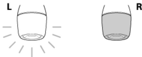
2. リモコンをL側の電球スピーカーに向け、STEREO/DOMBLE（モード切替）／SHIFT（シフト）ボタンを押しながら、▶■（再生／一時停止）／PAIRING（ペアリング）ボタンを約1秒間押す。
