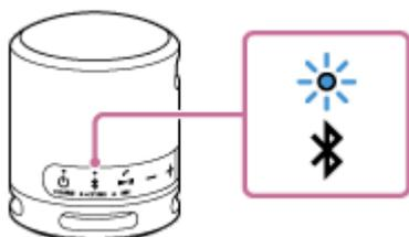
自购买或初始化扬声器以来（扬声器没有配对信息），首次将扬声器与BLUETOOTH设备进行配对后，扬声器在打开时会自动进入配对模式。继续执行步骤 4。
