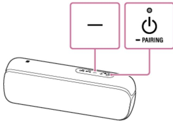
Der Lautsprecher wird initialisiert. Einstellungen wie Lautstärke usw. werden auf die werkseitigen Standardeinstellungen zurück gesetzt, und alle Pairing-Informationen werden gelöscht.
