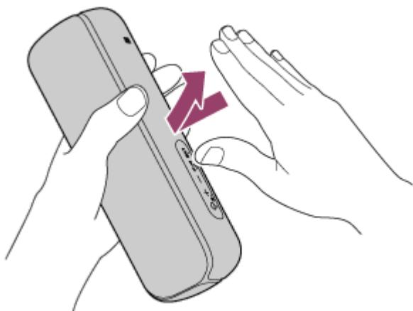
Die Oberfläche, wo Klangeffekte ausgegeben werden, wenn Sie die Oberseite, Vorderseite, beide Seiten oder Unterseite des Lautsprechers antippen.
