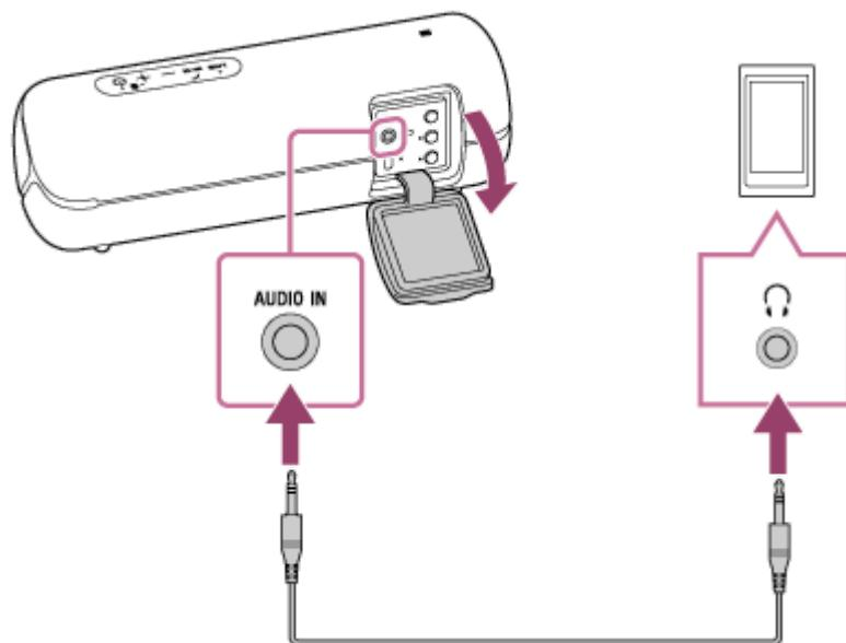
\*1 Wenn Sie ein Audiokabel (mit Stereo-Ministeckern) mit signifikantem Widerstand verwenden, ist der Ton möglicherweise schwächer. Stellen Sie daher sicher, dass Sie ein Kabel (mit Stereo-Ministeckern) ohne Widerstand verwenden.
