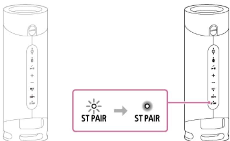
Une fois la connexion des enceintes avec la Fonction de jumelage stéréo établie, le témoin ST PAIR (Jumelage stéréo) des deux enceintes reste allumé et le témoin (BLUETOOTH) s'éteint sur l'une ou l'autre.
