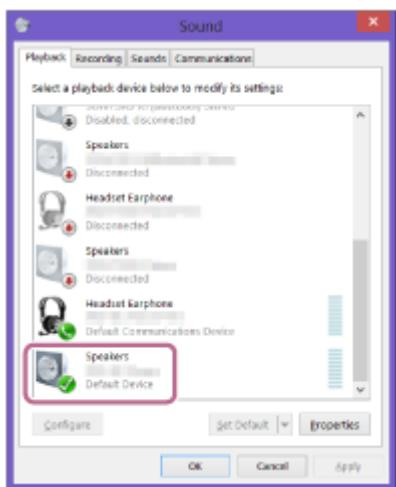
Se non è possibile fare clic su [Connect] per [SRS-XB32 Stereo], selezionare [Disable] per il [Default Device] su cui è correntemente presente il segno di spunta (verde).
