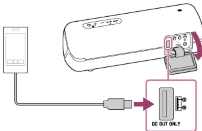
Quando si collega il diffusore a una presa CA, il dispositivo USB connesso avvia automaticamente la ricarica.
