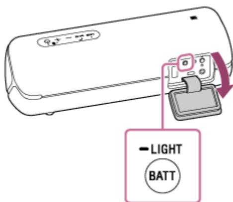
Se mantiver o botão premido novamente durante cerca de 3 segundos, a função de iluminação volta a ativar-se/desativar-se.
