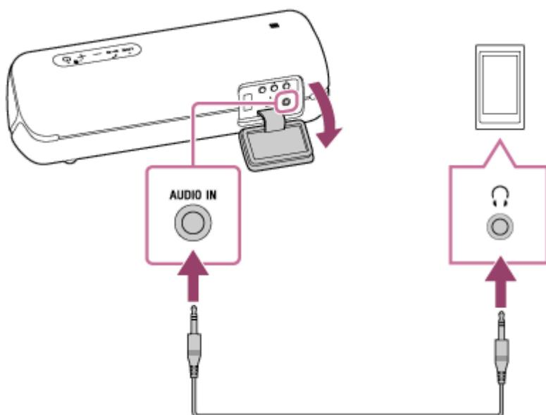
\*1 Se utilizar um cabo de som (com minifichas estéreo) com resistência significativa, o som pode estar mais baixo. Por isso, assegure-se de que utiliza um cabo (com minifichas estéreo) sem resistência.
