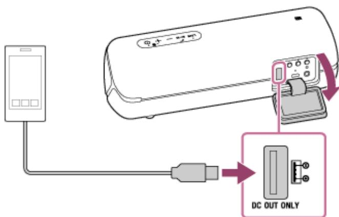
Quando ligar o altifalante a uma tomada de CA, o dispositivo USB ligado começa a ser carregado automaticamente.
