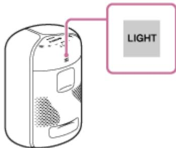
Jedes Mal, wenn Sie die LIGHT-Taste/
