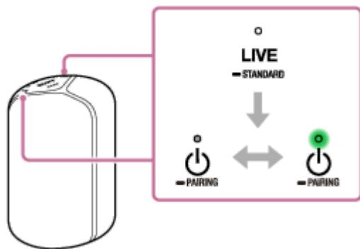
Wenn Sie die LIVE/ STANDARD-Taste etwa 3 Sekunden lang drücken, wechselt die Farbe der ⚡ (Strom)-Anzeige von Grün auf Weiβ um, und der Klangmodus wechselt auf den EXTRA BASS-Modus um.
