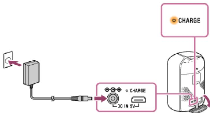
Die CHARGE-Anzeige leuchtet während des Ladevorgangs orangefarben auf. Der Ladevorgang ist in etwa 6 Stunden\* abgeschlossen und die Anzeige erlischt.
