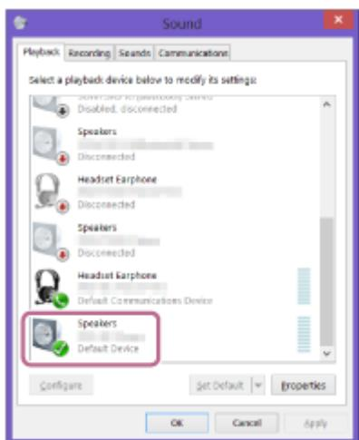
Si no puede hacer clic en [Connect] para [SRS-XB43 Stereo], seleccione [Disable] para el [Default Device] que actualmente tenga una marca de verificación (verde).
