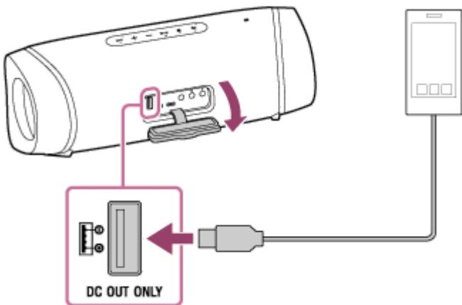
Al conectar el altavoz a una toma de CA, el dispositivo USB conectado comenzará a cargarse automáticamente. Si el altavoz se está alimentando únicamente con la batería incorporada, vaya al paso ②.
