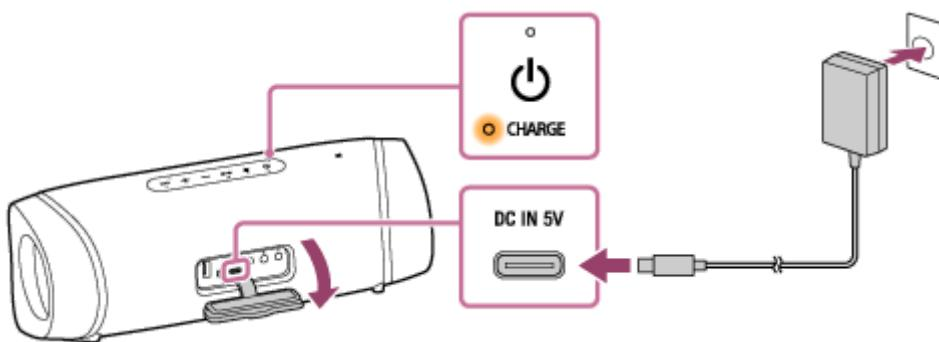
La carga de la batería se iniciará y el indicador CHARGE se iluminará en naranja. La carga se completará en unas 5 horas \* y el indicador se apagará.
