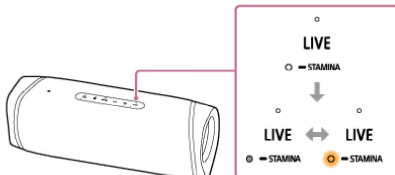
Si vuelve a mantener pulsado el botón LIVE/ STAMINA durante unos 3 segundos, el indicador STAMINA se apagará y el efecto de sonido volverá al modo EXTRA BASS.
