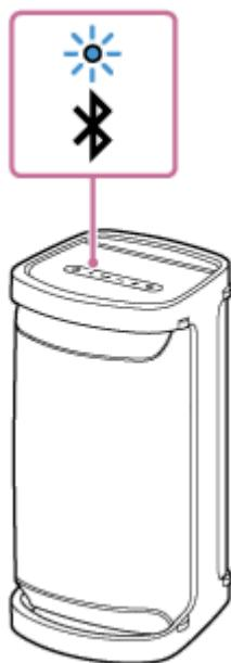
Selepas anda memasangkan pembesar suara dengan peranti BLUETOOTH buat kali pertama setelah membeli atau memulakan pembesar suara (pembesar suara tidak mempunyai maklumat berpasangan), pembesar suara akan memasuki mod berpasangan secara automatik apabila ia dihidupkan. Teruskan ke langkah **4**.
