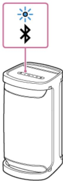
Selepas anda memasangkan pembesar suara dengan peranti BLUETOOTH buat kali pertama setelah membeli atau memulakan pembesar suara (pembesar suara tidak mempunyai maklumat berpasangan), pembesar suara akan masuki mod berpasangan secara automatik apabila ia dihidupkan. Teruskan ke langkah ④.
