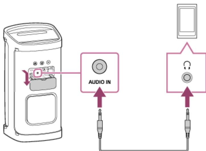
\*1 若使用具有高電阻的音源線（配備立體聲迷你插頭），喇叭發出的聲音可能會較低。因此，請務必確認使用的音源線（配備立體聲迷你插頭）不具電阻。
