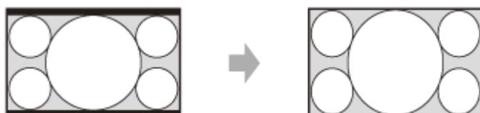
\*3 Wenn die Anzeigeposition auf ein 16:9-Signal eingestellt ist und ein 4:3-Signal eingespeist wird, passt das Bild vertikal möglicherweise nicht auf die Projektionsfläche. In diesem Fall wählen Sie [Voll 3].
