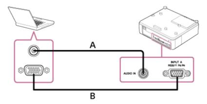
A: Audio cable (stereo mini plug) (not supplied)
