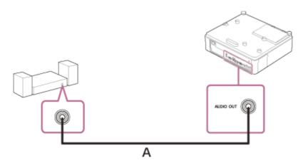
A: Audio cable (Stereo mini plug) (not supplied)
