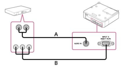
**A:** Audio cable (Pin plug x 2 - Stereo mini plug) (not supplied)
