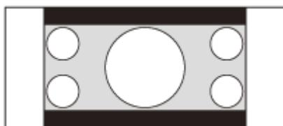
Wenn die Taste POSITION gedrückt wird, wird das 2,35:1-Bild so vergrößert, dass es die Projektionsfläche füllt.
