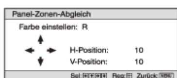
Stellen Sie den Grad der Korrektur für die horizontale Richtung (H) mit der Taste **◀ / ▶** (Links/Rechts) und für die vertikale Richtung (V) mit der Taste **↑ / ↓** (Auf/Ab) ein.
